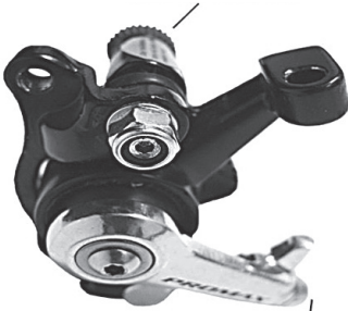
Klemmschraube für Bremszug
