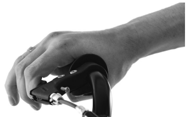
Korrekte Position des Bremshebels
